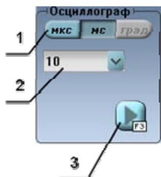
Панель содержит управляющие элементы для настройки параметров горизонтальной развертки и запуска/остановки осциллографа:
