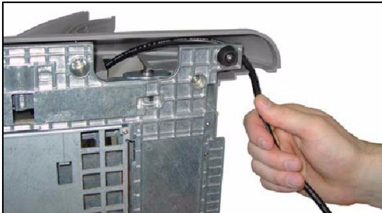
Рис. 6-1 Прокладка сетевого кабеля
