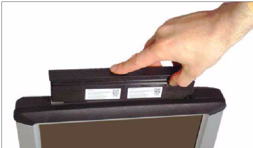
Рис. 4-1 Установка блока аккумулятора в тестер
