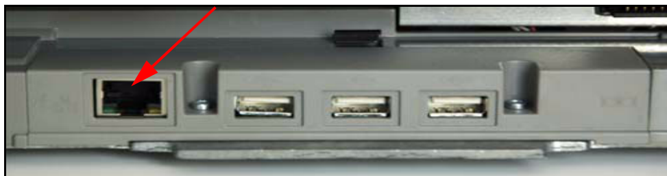
Рис. 6-3 Интерфейсный модуль базовой станции, стрелка на разъеме RJ45, справа от него — три разъема USB
