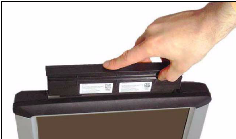
Рис. 4-1 Установка блока аккумулятора в тестер
