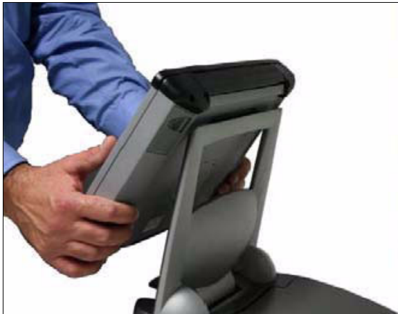
Рис. 6-4 Вставка тестера в базовую станцию
