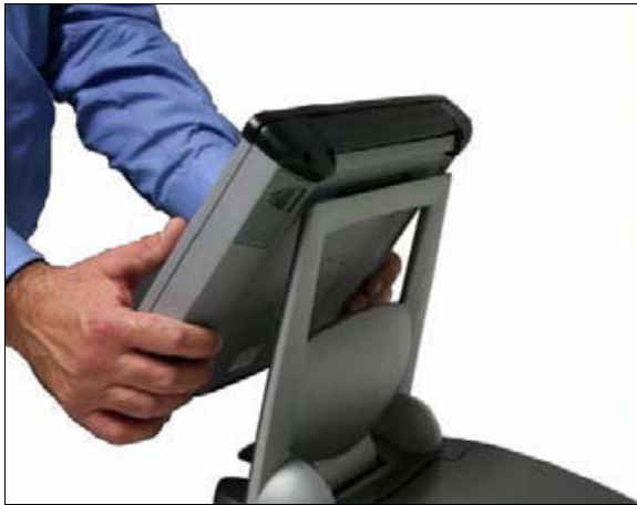
Рис. 6-4 Вставка тестера в базовую станцию
